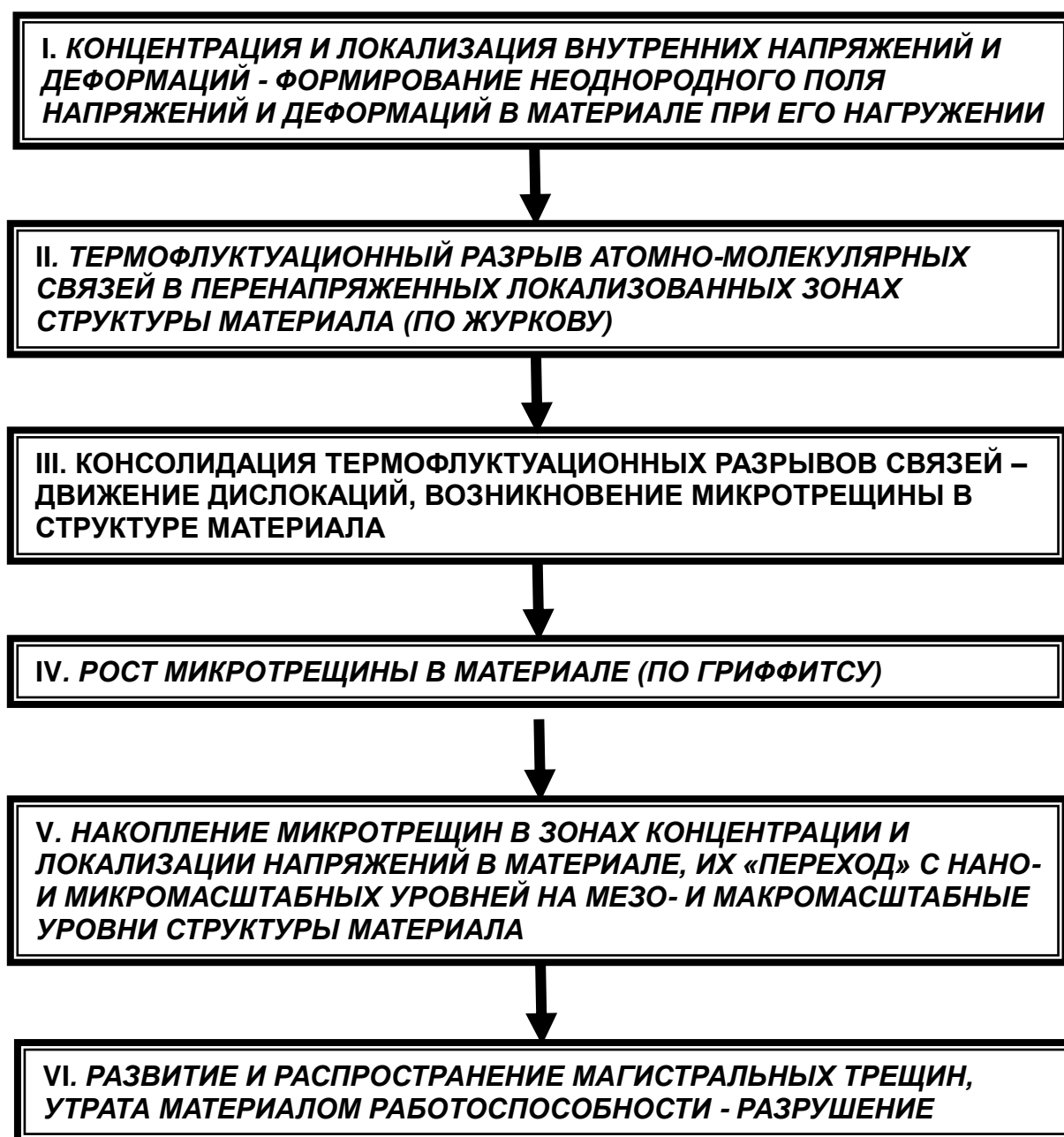
Рис. 2. Этапы разрушение материалов с позиций интегративного механо-физико-химического подхода
